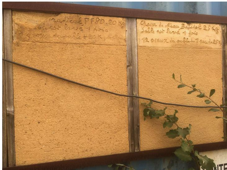
*Echantillons d'enduits réalisés par la carrière avec les chaux Batidol\**
